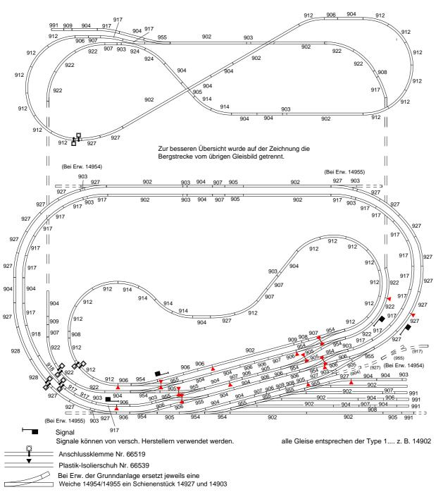
Die Weichen des Überholgleises/Abstellgleises können durch Entfernen der äußeren Drahtbrücken in zweiseitig wirkende . Stop-Weichen verwandelt werden. Dadurch können Loks nach Umstellen der Weichen stromlos abstellt werden.
