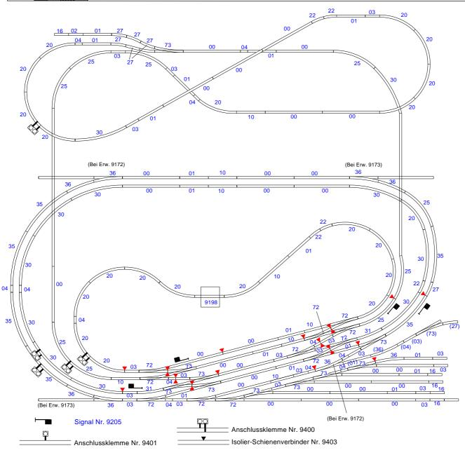
Die Weichen des Überholgleises/Abstellgleises können durch Entfernen der auesseren Drahtbrücken in zweiseitig wirkende Stop-Weichen verwandelt werden. Dadurch können Loks nach Umstellen der Weichen stromlos abstellt werden.
